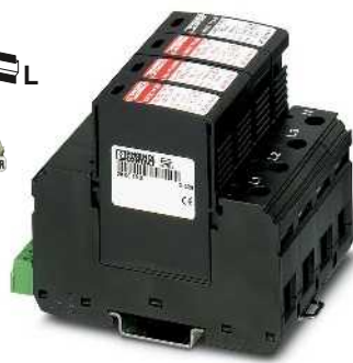
5 condutores, L1, L2, L3, N, PE (circuito 3+1)
