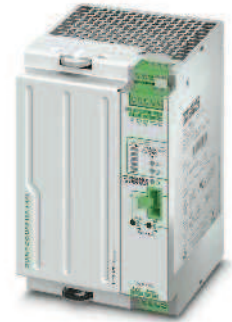
Fonte de alimentação ininterrupta com acumulador de energia integrado, 24 V CC / 24 V CC, 10 A, 3.4 Ah
