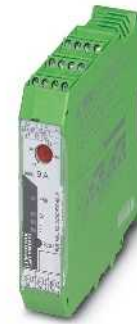
para acionamento de motores CA 3~ até 550 V CA/3 x 2 A
